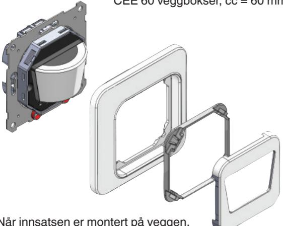
Bevegelsesdetektoren kan monteres i CEE 60 veggbokser, cc = 60 mm.
