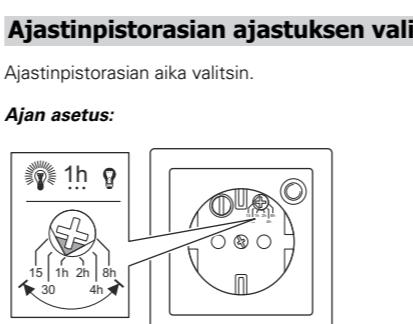
Ajastinpistorasian aika valitaan käänämällä valitsinta haluttuun aikaan. Ajastinpistorasiassa on kuusi eripituisista aikajakoista (15 min, 30 min, 1 h, 2 h, 4 h ja 8 h). Kuorma kytkeytää pääle kannessa olevalla painikkeella.
