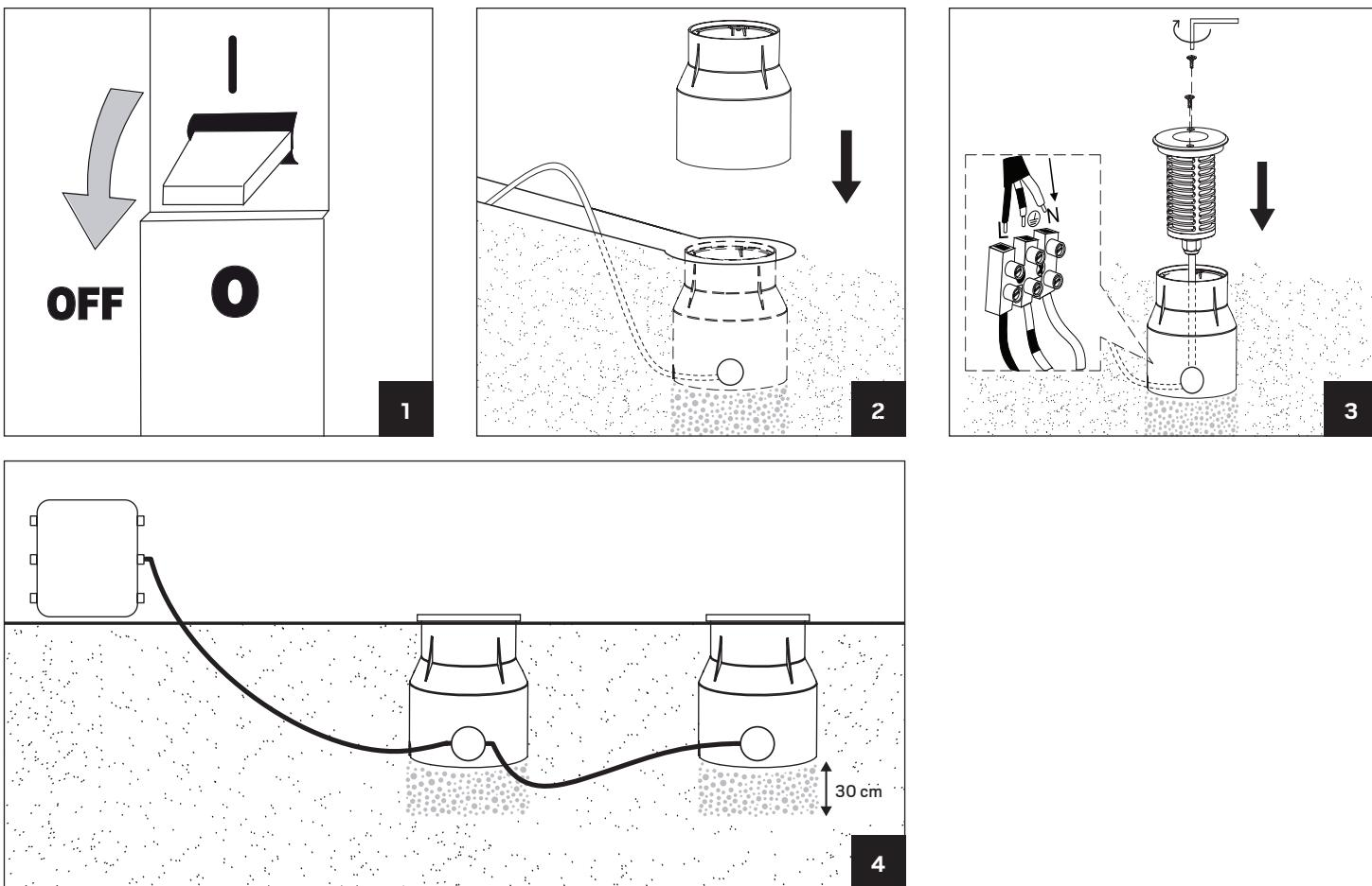
4. Armaturen bör placeras på en dränagebörd av grövre stenmaterial på minst 30 cm.
