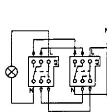
2 polet styring av småmotorer (markise) 1 polet styring av småmotorer (markise)
