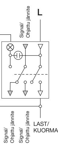
**SV** 1-polig Ljus i brytaren när kortet är ur. Separat vxl. kontakt för styrsignal.
